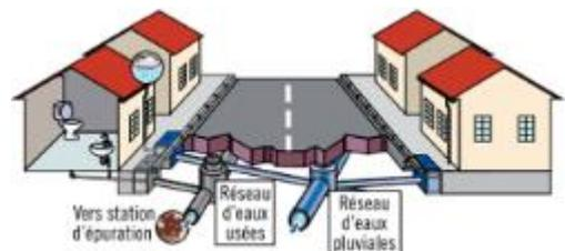
En temps de pluie, les eaux usées ne risquent plus d'être diluées et déversées au milieu naturel. Elles vont toutes en station d'épuration. L'avantage de ce type de réseau est de ne pas introduire de charges de pollution minérale ou chimique du flux d'eaux pluviales dans la station d'épuration.
